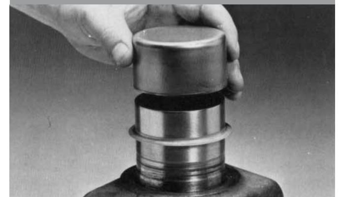
6. Führen Sie das Werkzeug über den Sleeve
