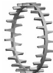
Abb. 6: Einteiliger, gefräster, innenringgeführter Messing-Fingerkäfig.
