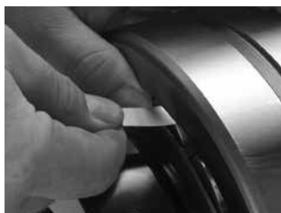
Abb. 14. Messung des internen Radialspiels (RIC) vor der Installation.
