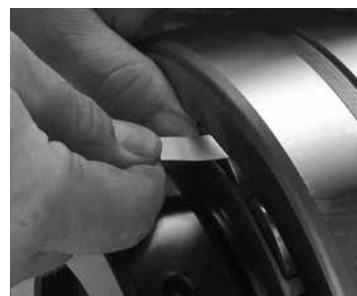
Abb. 18. Messung des internen Radialspiels (RIC) vor der Installation.
