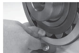
Nach dem Einbau muss das RIC am unbelasteten Rollkörper überprüft werden.
